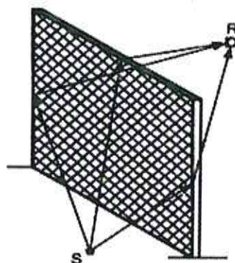
Рисунок 10.1 – Различные пути распространения звука вокруг экрана
